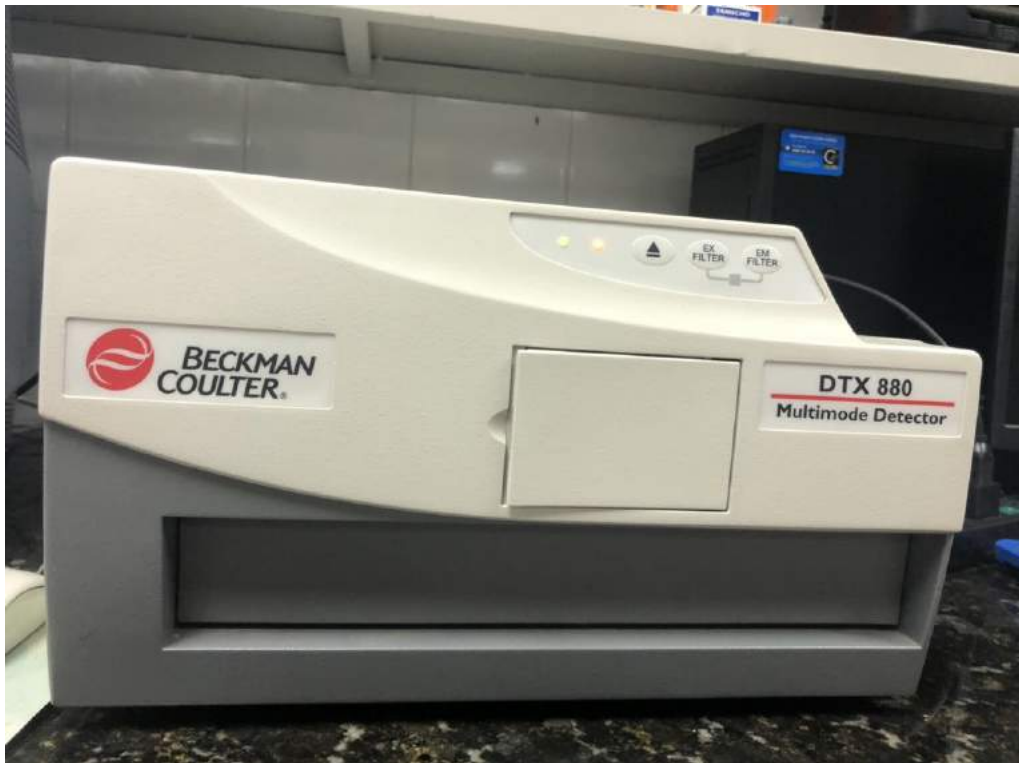
Hình 2.4. Máy đo mật độ quang DTX 880 do hãng BCE – Mỹ sản xuất.
